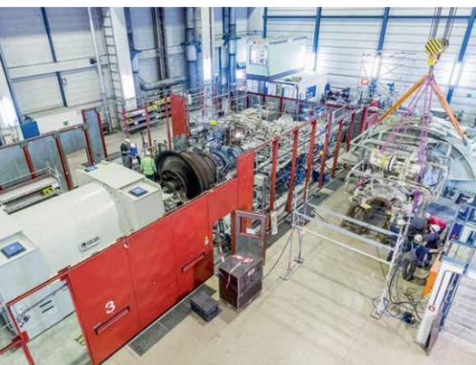
**Oben:** Geöffnete Turbine und Generator im Maschinenhaus
