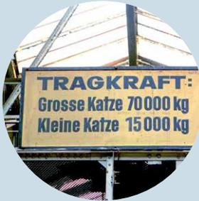
**LAUFKATZEN** spielen in unseren Kraftwerken eine große Rolle. Eine Laufkatze ist kein schnelles Tier, sondern ein bewegliches Kranbauteil, an dem die Greifer hängen. Dank der Krankatze kann der Greifer an zwei Schienen hin- und herfahren.
