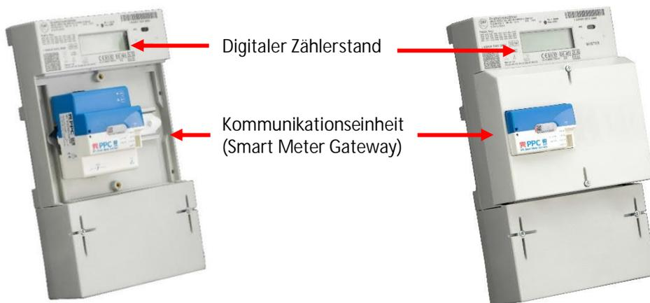
Verfügt Ihr Stromzähler über die beiden oben aufgeführten Bestandteile haben Sie iMSys.
