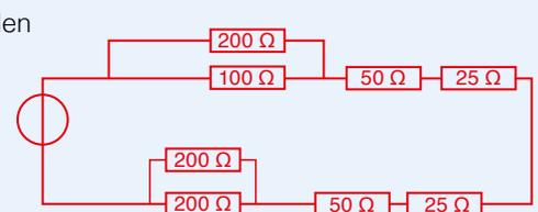
$R \text{ (oben)} = (100\Omega \times 200\Omega) / (100\Omega + 200\Omega) + 50\Omega + 25\Omega$
